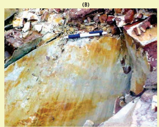
Fig.1 - Ocorrência de falhas geológicas em Manaus na Av. do Turismo. Essa estrutura representa a falha que controla a margem esquerda do rio Negro (A). Em (B) estrias de atrito no "Arenito Manaus" produzido pela movimentação tectônica na zona de falha
