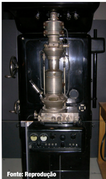
Figura 3. Réplica do primeiro microscópio eletrônico de transmissão inventado por Ruska e Knoll em exposição em um museu de Munique.
