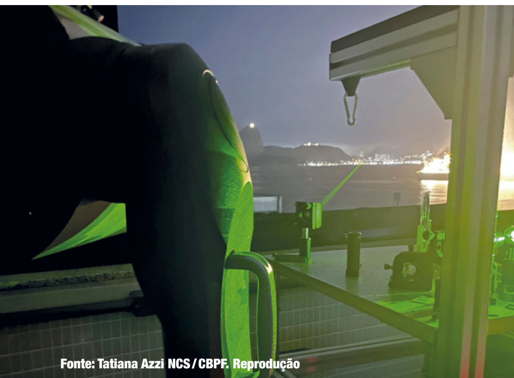
Figura 2. Experimentação com o feixe de laser que a Rede Rio Quântica utilizará para ligar a UFF ao CBPF.
