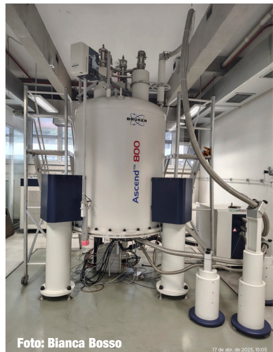
Figura 1. Espectrômetro de Ressonância Magnética do Grupo de Pesquisa em Ressonância Magnética Nuclear de Proteínas
