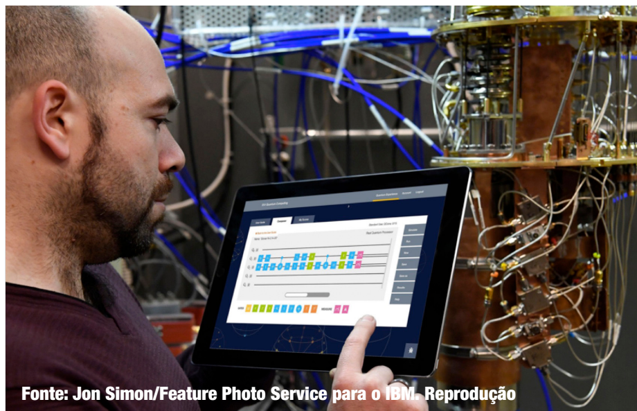
Figura 1. Cientista usa o IBM Quantum Experience em um tablet no IBM Quantum Lab que mostra um refrigerador de diluição aberto
